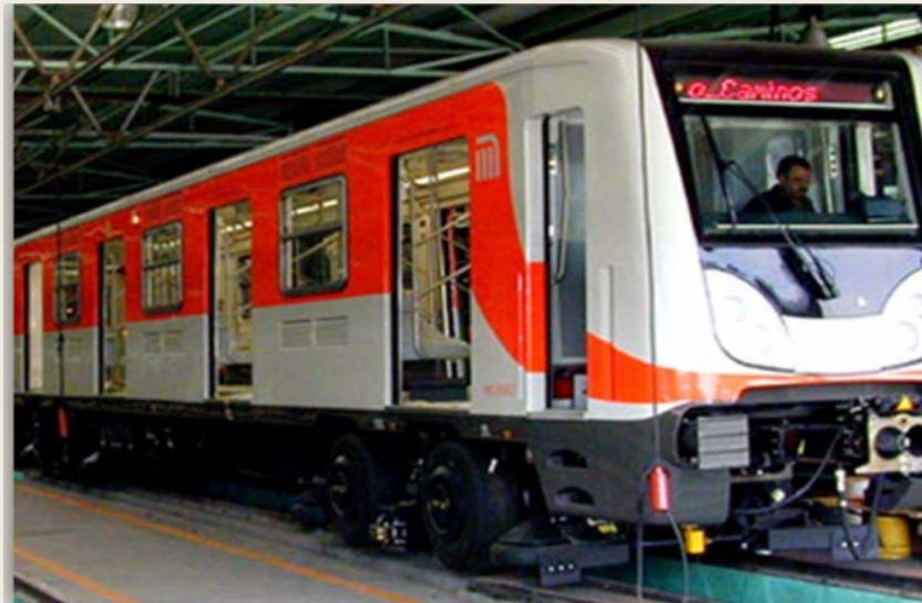
**Mantenimiento Mayor para 45 trenes de Línea 2 de rodadura neumática de 9 carros, modelo NM-02.**
