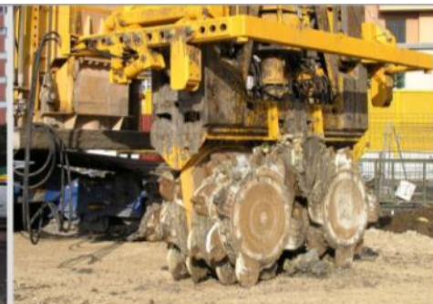
4 - 5. Particolari dell'attrezzatura di scavo dell'idrofresa - ruote fresanti dotate di picchi e coltelli
