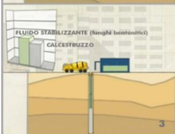
2. Schema delle fasi principali: 1) scavo con fluido stabilizzante; 2) posa armatura; 3) getto con risalita fluido stabilizzante
