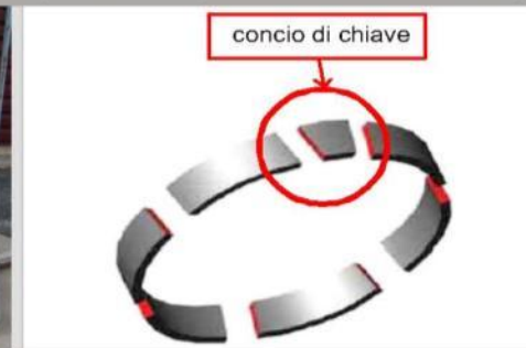
6. Schema di anello a 7 conchi: 6+1 di chiave
