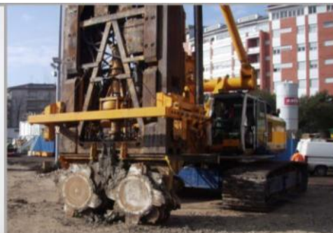
4 - 5. Particolari dell'attrezzatura di scavo dell'idrofresa - ruote fresanti dotate di picchi e coltelli
