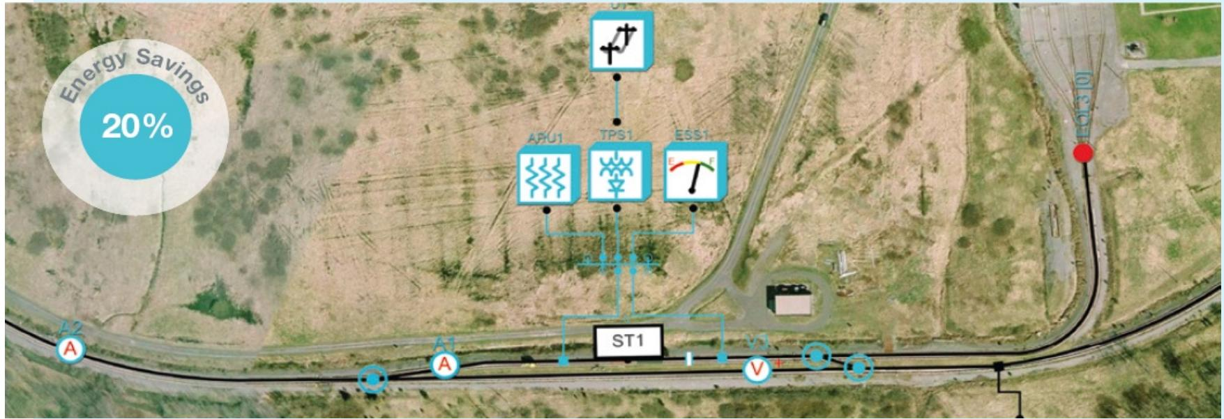
Herramienta electrónica que simula y optimiza el diseño y mejora el consumo de un sistema de distribución de energía de todo un sistema de transporte, generando ahorros de energía de hasta 20% y por lo tanto reduciendo los costos de operación de nuestros clientes.
