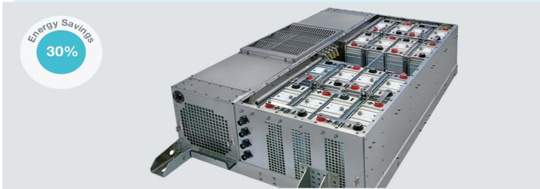
Ultracapacitores de doble capa, almacenan energía generada durante el frenado de los vehículos y la usan durante la aceleración y operación. Aplicado a trenes ligeros, el sistema ha probado consistentemente durante varios años el ahorro de hasta el 30% de la energía. Es además un componente indispensable para la operación sin Catenaria “Catenary Free Operation” (CFO) en secciones cortas
