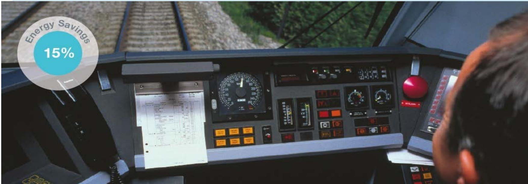
Es una herramienta de Software inteligente para ayudar a los conductores con recomendaciones de velocidad y aceleración/desaceleración, minimizando la energía necesaria para que un tren llegue con puntualidad.
