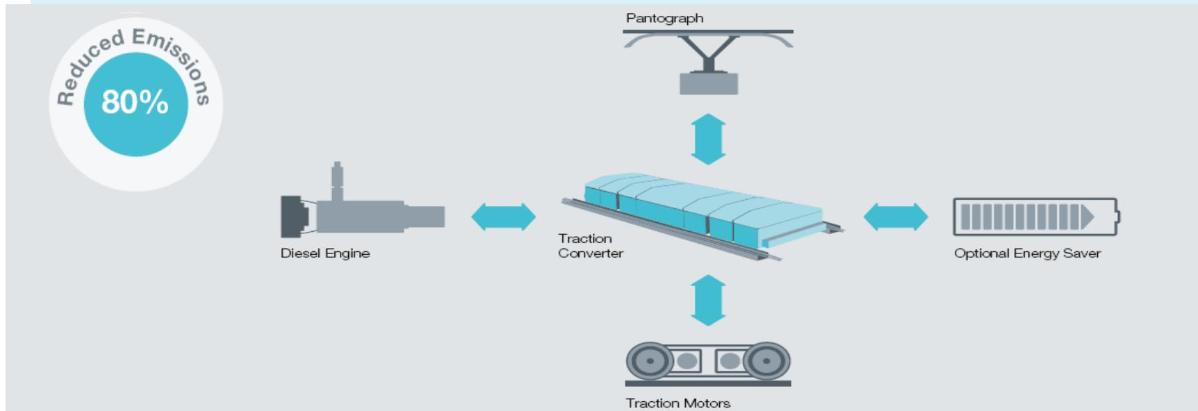
Tecnología Híbrida que permite que un vehículo opere de forma eficiente en sistemas de vías electrificados y no electrificados debido al uso de una cadena de tracción común en ambos casos de energía eléctrica o por medio de diesel. Resulta en un uso mínimo de combustibles fósiles con una reducción de hasta el 80% en la contaminación del aire. Los operadores también ganan beneficios económicos en consumos de combustible que pueden reducirse hasta en un 40%
