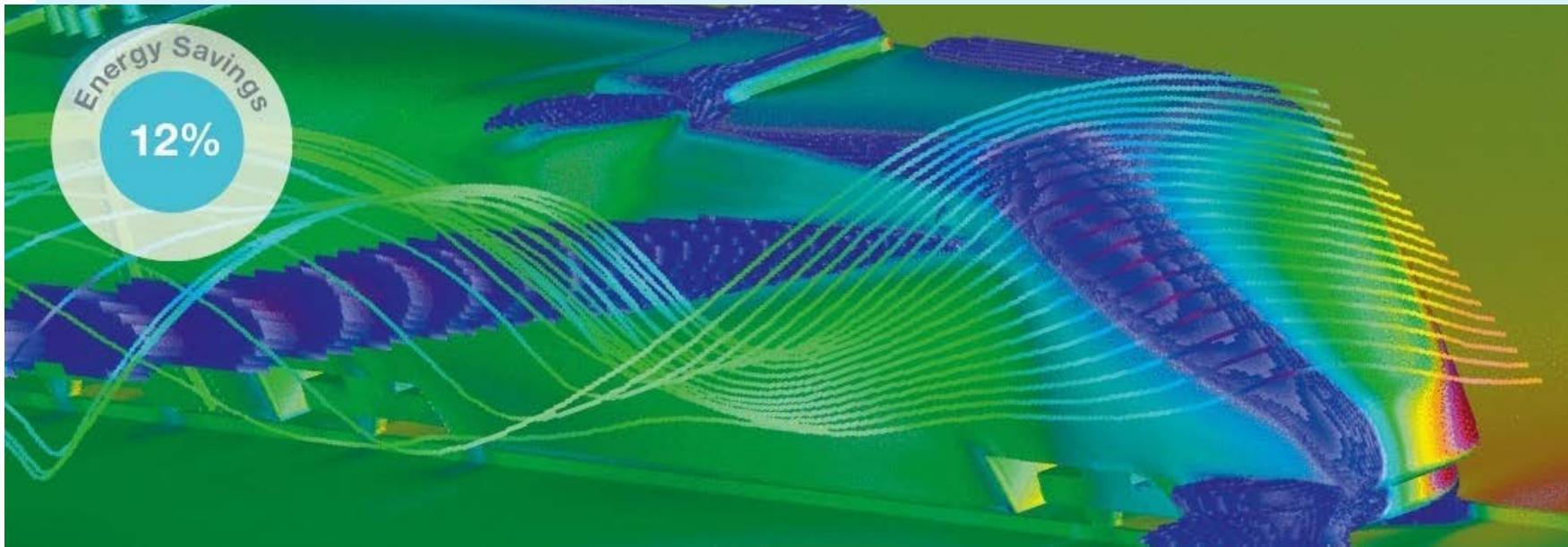
Ahorros de energía de hasta 8% en servicios regionales y hasta 15% en alta velocidad se logran al reducir el drag aerodinámico hasta un 25% usando diseño de frentes optimizados para el cliente "AeroEfficient"
