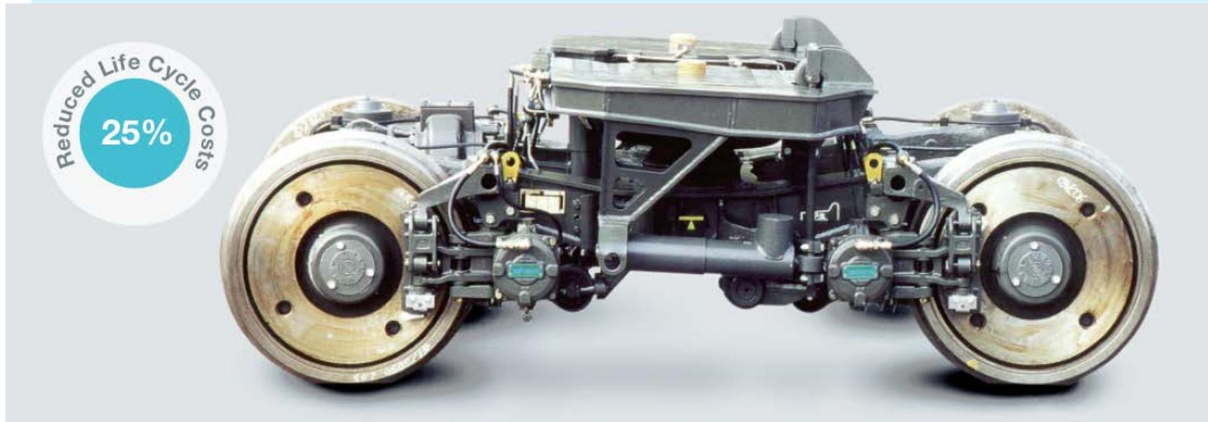
Parte del portafolios Bombardier que permite ahorros significativos de consumo de energía y emisión de ruidos. Caracterizado por un diseño extremadamente compacto y de bajo peso. Logrando una reducción de peso de 30% de la masa total.
