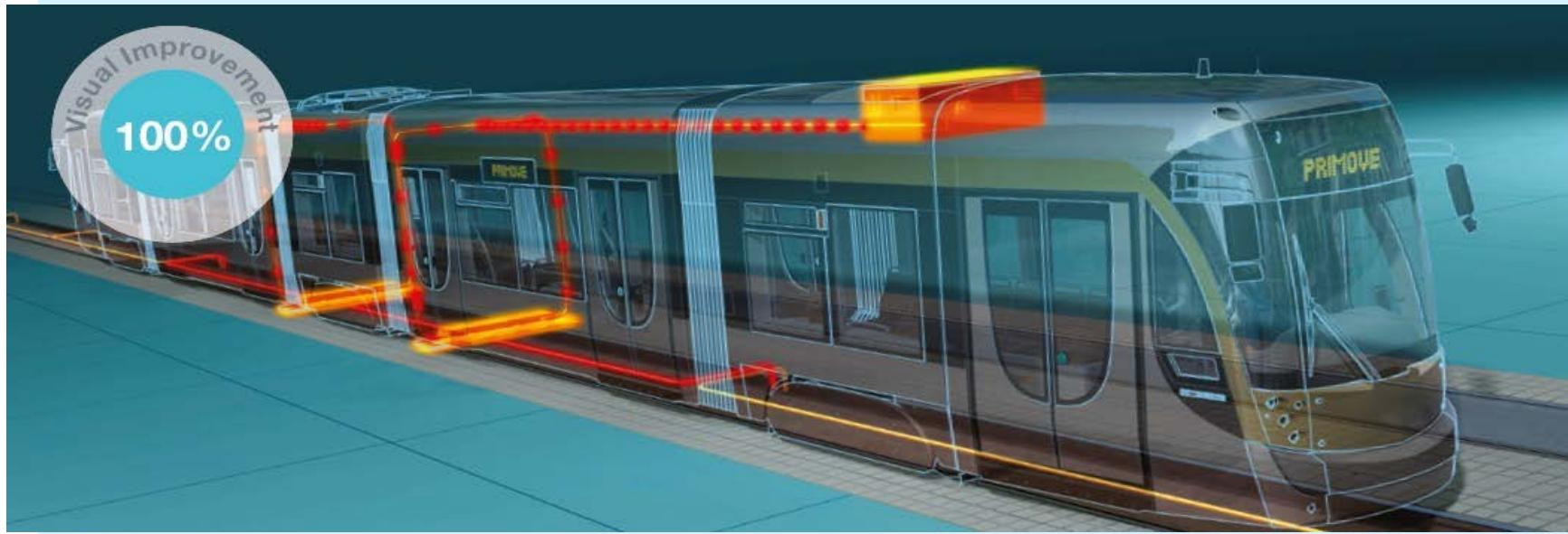
Es la única solución que provee servicio sin catenaria de forma continua para tranvías, basada en transferencia de energía por medio de sistemas sin contacto de inducción de corriente. El suministro eléctrico esta oculto debajo del vehículo y debajo de las vías eliminando la necesidad de cables de catenaria y postes, además de reducir el desgaste de las partes, asegurando una operación segura en todas las condiciones climáticas.
