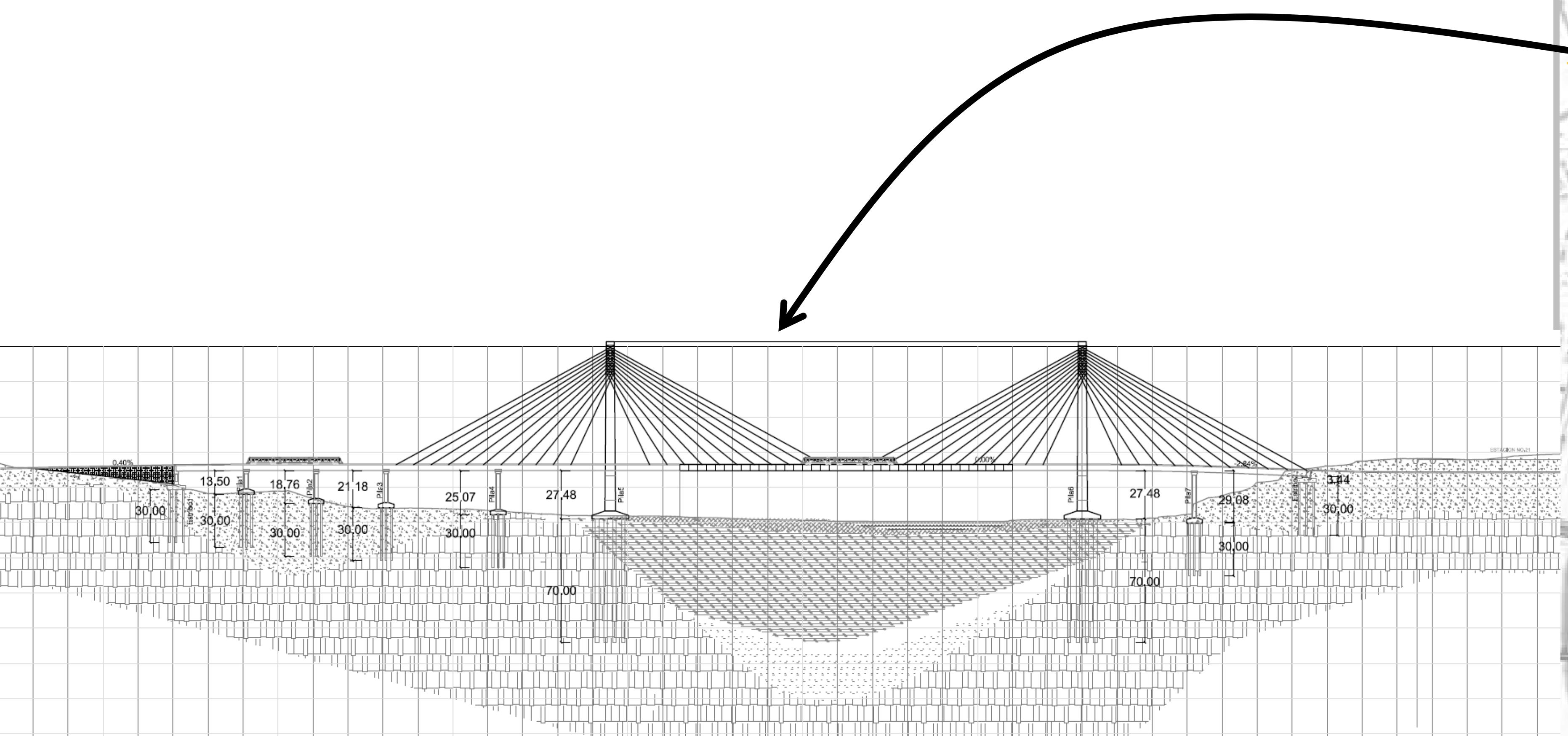
Compuesto por 2 pilas principales y 6 pilas secundarias de hormigón armado.
