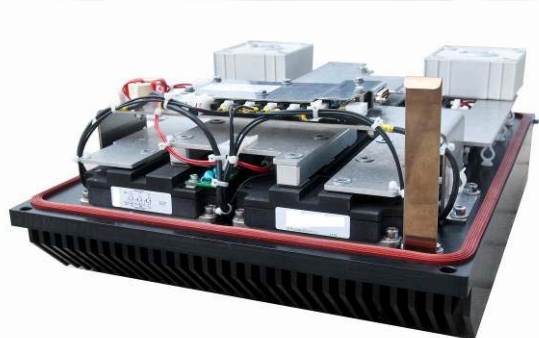
Módulo de tracción refrigerado por aire natural
