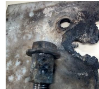
tonillo y fixación corroídos
