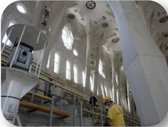
Medición robotizada de movimientos en interior y exterior de La Sagrada Familia
