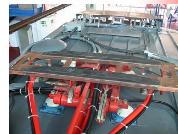
fuerza interacción pantógrafo-hilo
