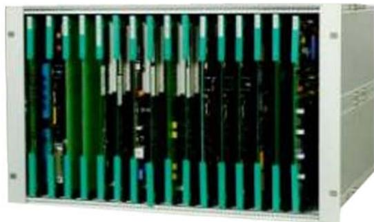
El Sistema TBS500 se complementa con el Platform Screen Doors (PSD) que hace de interface con el Sistema de Puertas de Andén, y permite generar las órdenes de apertura y cierre de las mismas de forma sincronizada.
