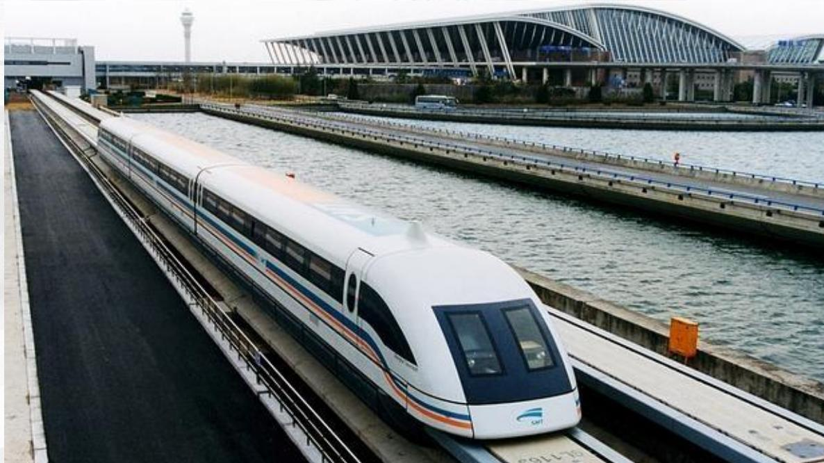
El principio de funcionamiento de este tren es su propulsión, levitación y guiado por medio de la fuerza electromagnética que actúa entre los imanes y el superconductor.
