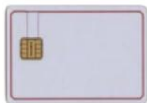
Tarjeta con un chip de doble interfaz y aplicación EMV
