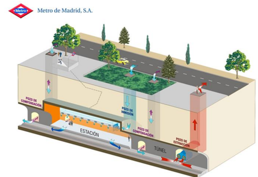
ESQUEMA DE INSTALACIÓN TIPO DE VENTILACIÓN DE METRO DE MADRID
