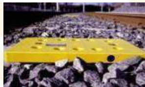
EBI* Link Equipamiento de vía ATC
