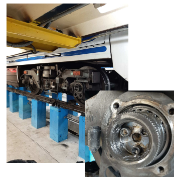
Correctivo catastrófico: eje bloqueado
