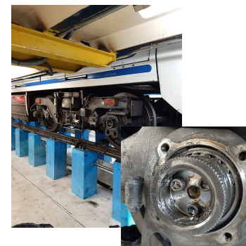
Correctivo catastrófico: eje bloqueado
