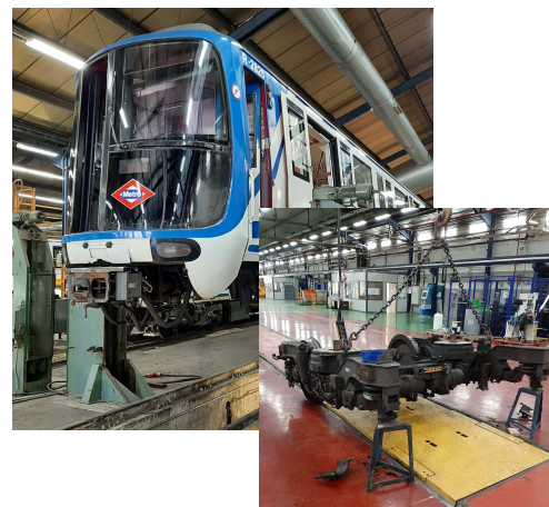
Correctivo catastrófico: eje bloqueado
