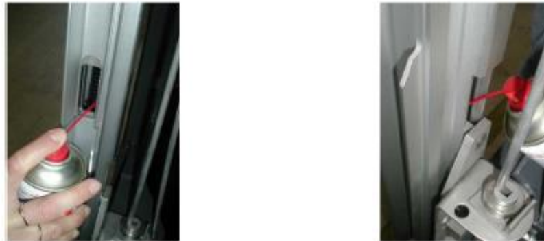
Figura 6 Engrase de los muelles de compresión
