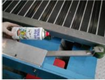
Figura 7 Reengrase de las roldanas portantes y las roldanas guía (esquemáticamente)
