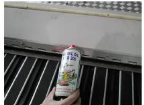
Figura 8 Reengrase de la bisagra corrida de la trampilla del puente (esquemáticamente)
