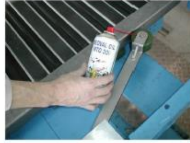
Figura 7 Reengrase de las roldanas portantes y las roldanas guía (esquemáticamente)
