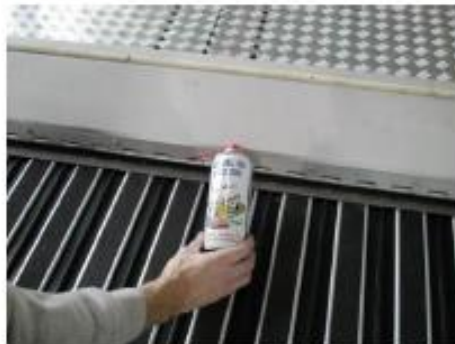
Figura 8 Reengrase de la bisagra corrida de la trampilla del puente (esquemáticamente)
