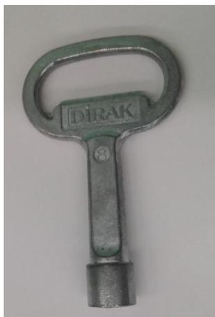
Llave L: de uso exclusivo para trenes CAF de segunda generación. Se diseño para los Conductores de los vehículos ferroviarios debido al diseño de la puerta y chapa de los trenes CAF.
