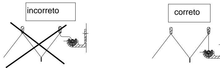
Ilustração 14: Fixação e alinhamento do tecido de conexão - esquemático
